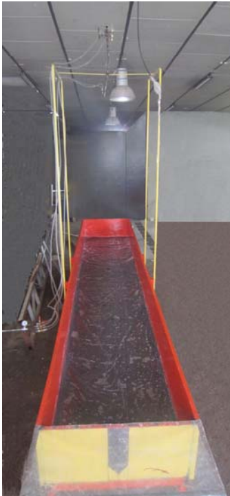
شکل ۱. زیرحوضه‌ی آزمایشگاهی به همراه سیستم شبیه‌ساز بارش در ارتفاع ۳ متری از سطح نایلون.
